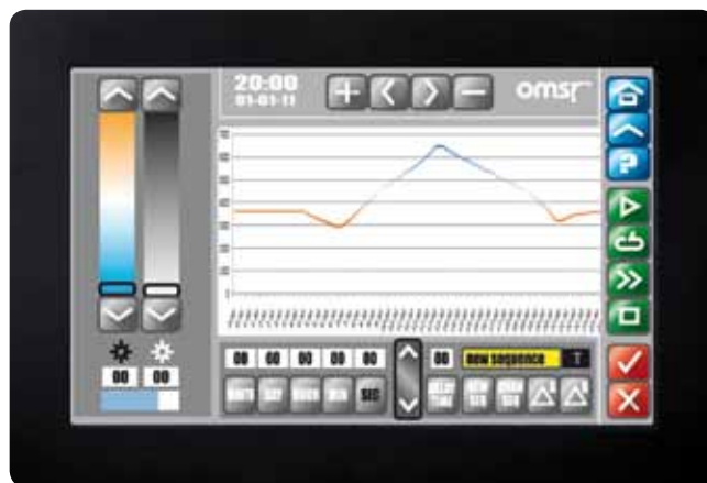
Dotykový panel osvetľovacieho systému poskytuje všetky potrebné informácie a možnosti voľby – tu napr. komfortnú zmenu teploty chromatickosti v priebehu dňa
